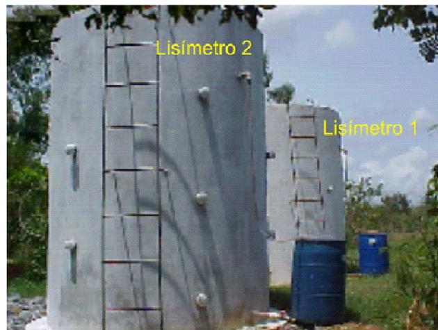
**Figura 3.1.** Lisímetros em operação construídos no aterro controlado da Muribeca (ALCÂNTARA, 2007)
